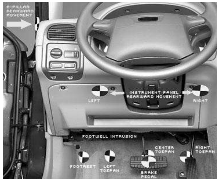
Рисунок 3. 1 – Типова схема вимірів деформацій салону після фронтального удару
