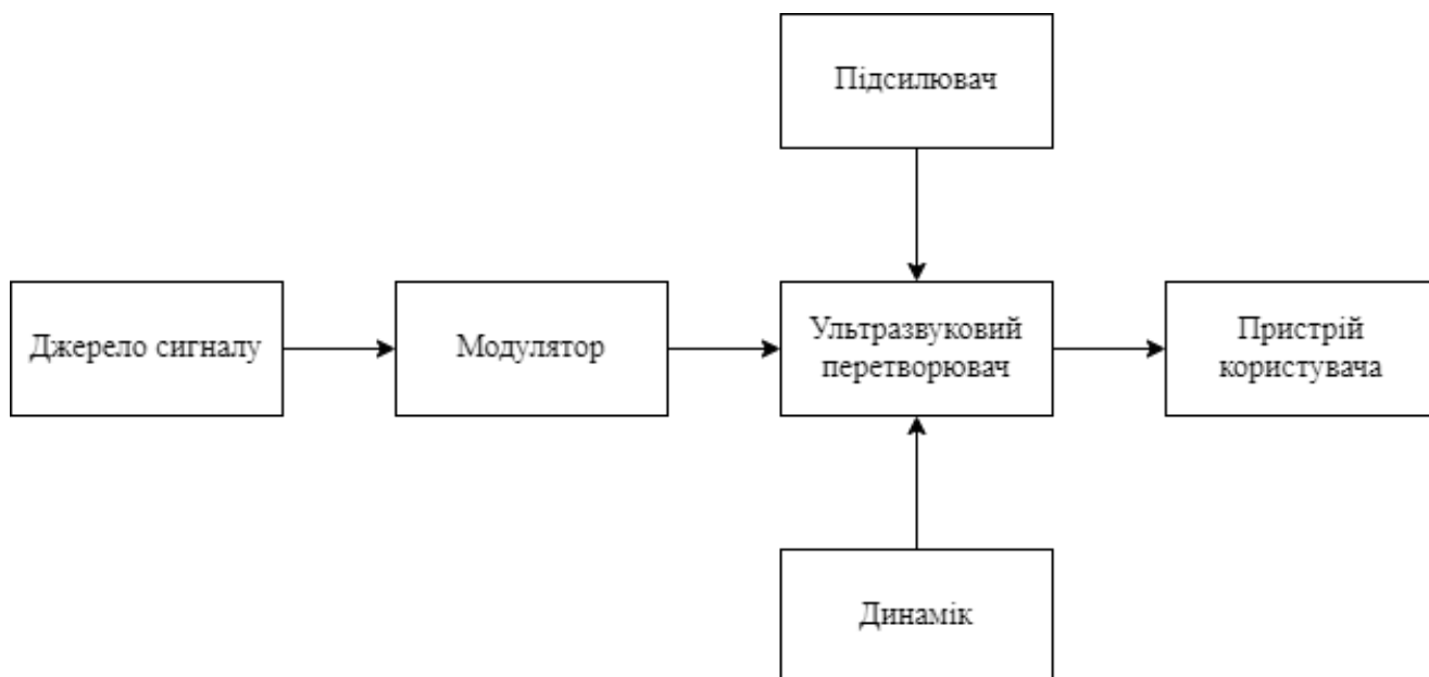
Рисунок 3.4 – Блок-схема передавача голосових команд для здійснення «DolphinAttak»
