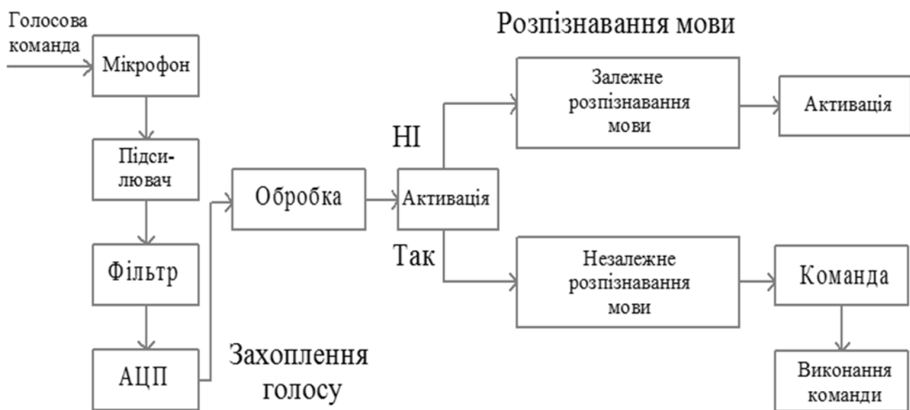
Рисунок 2.7 – Схема СГК з прийому голосових команд та подальшого їхнього виконання
