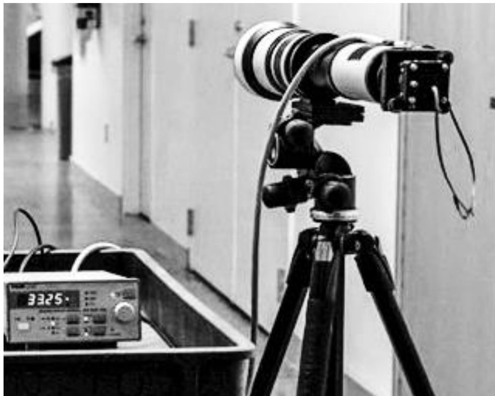
Рисунок 2.8 – Спеціальний пристрій (лазер) для проведення атаки світловими командами [59]
