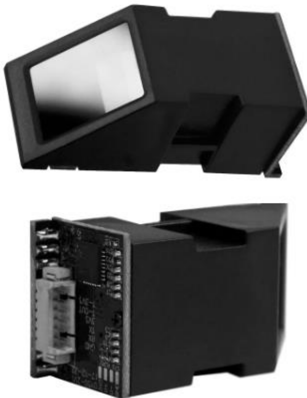
Рисунок 4.4 – Сканер відбитків пальців FPM10A [75]
