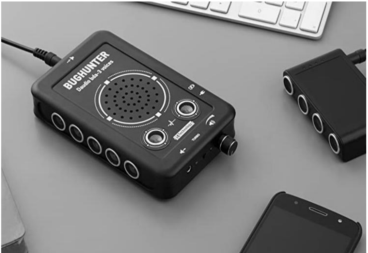
Рисунок 3.2 – Ультразвуковий блокатор записів [63]
