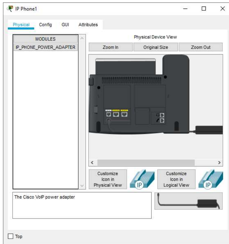
Рисунок 2.10-Підключення до живлення IP-телефону в програмі Cisco Packet Tracer
