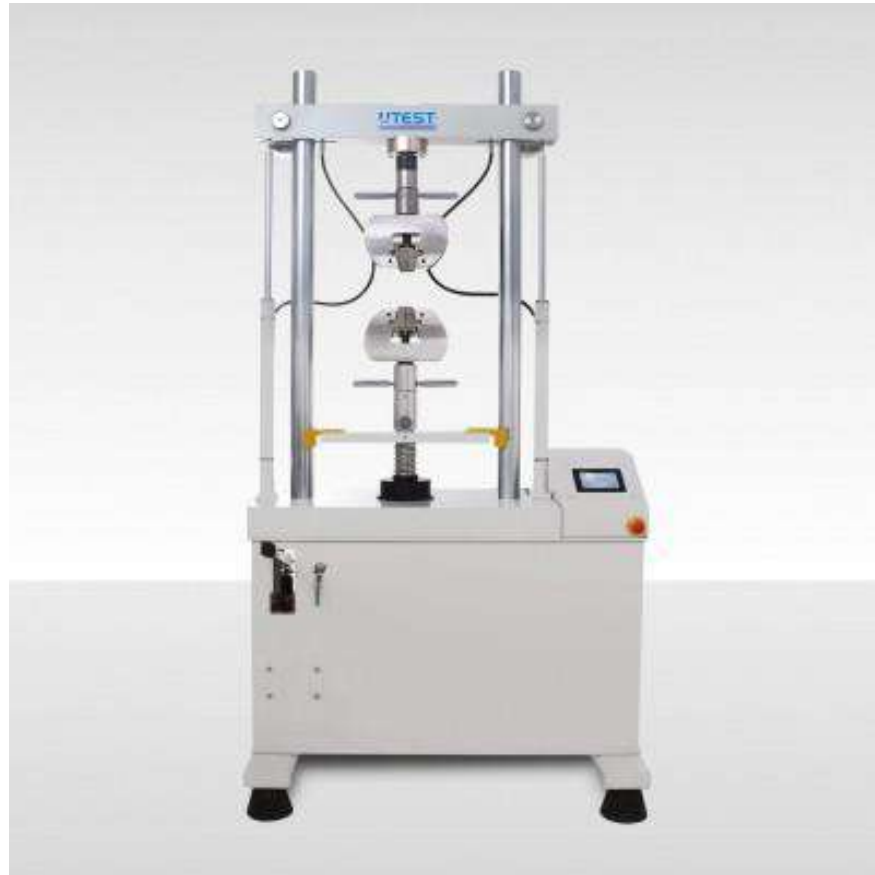
Рисунок 3.6 – Універсальна електромеханічна випробувальна машина моделі UTM-8100.SMD2, 100 кН
