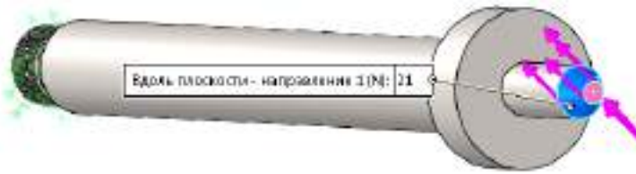
Рисунок 5.2 – Работа з 3D-моделлю пальця в SolidWorks Simulation: а – закріплення, б – прикладення навантаження
