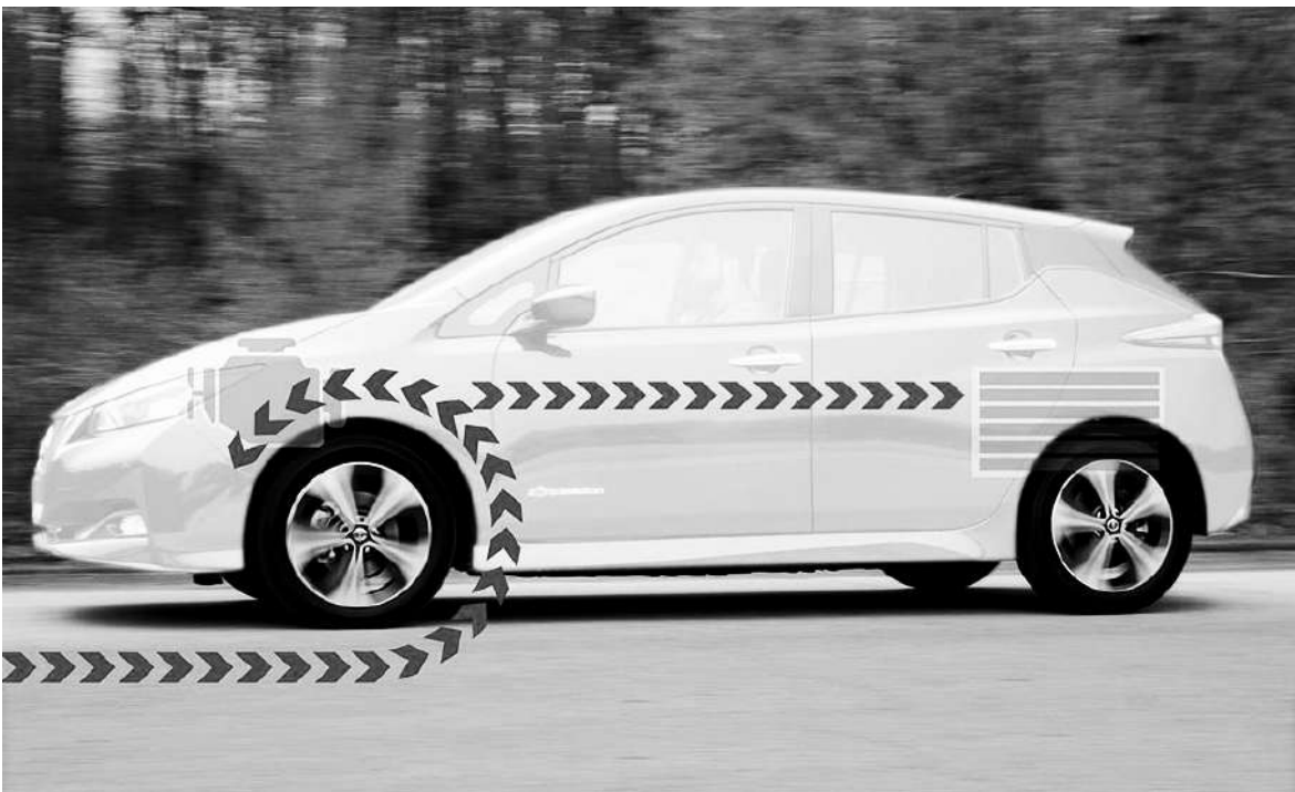
Рисунок 15 – загальна схема рекуперації електромобіля
