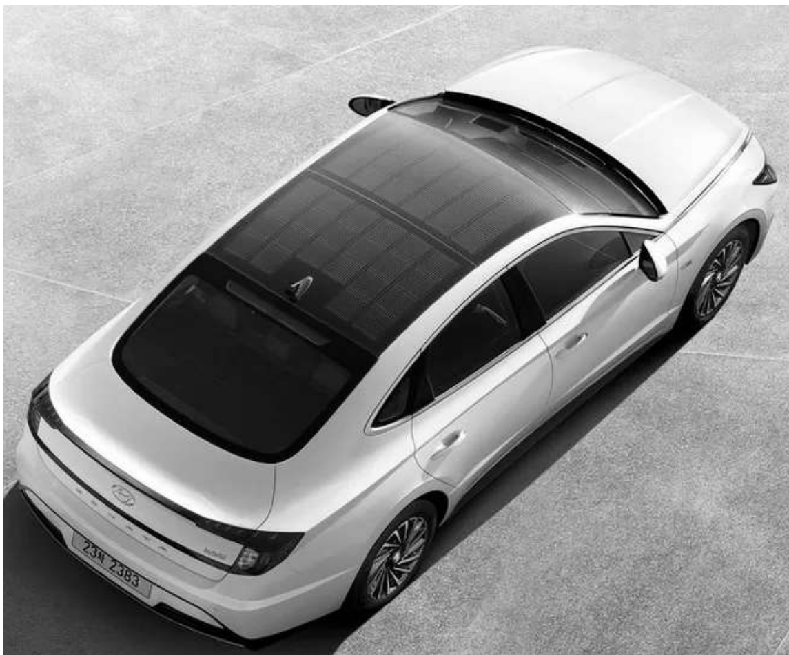
Рисунок 13 – приклад застосування сонячних панелей на відкритих частинах електромобіля
