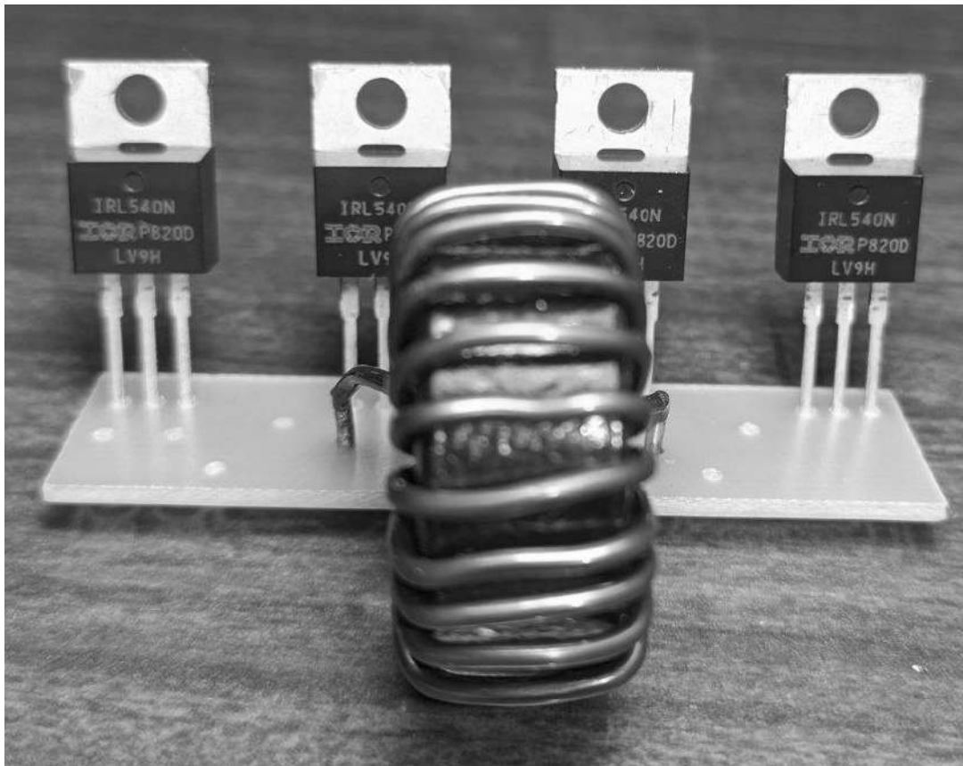
Рисунок 54 – Тестова плата топології Buck-Boost. Силова частина. Передня сторона плати
