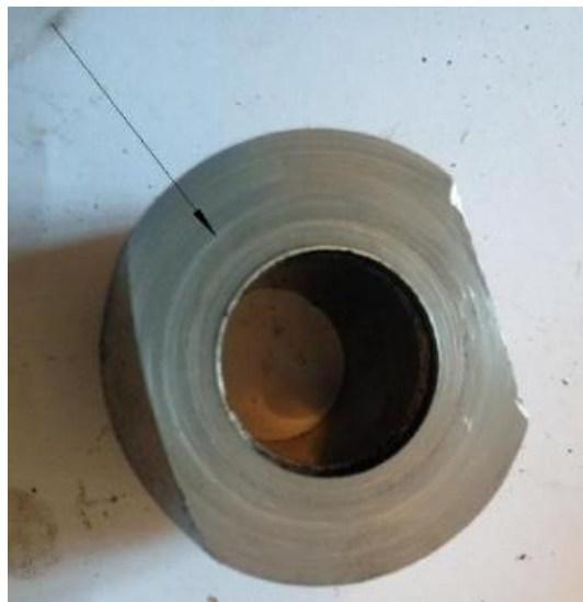
Рисунок 2.3 – Вигляд зношеної торцевої частини втулки насоса НШ
