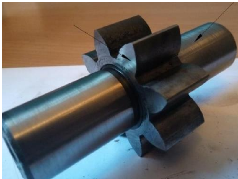
Рисунок 2.4 – Вигляд зношеної цапфи і торця шестерні насосу НШ
