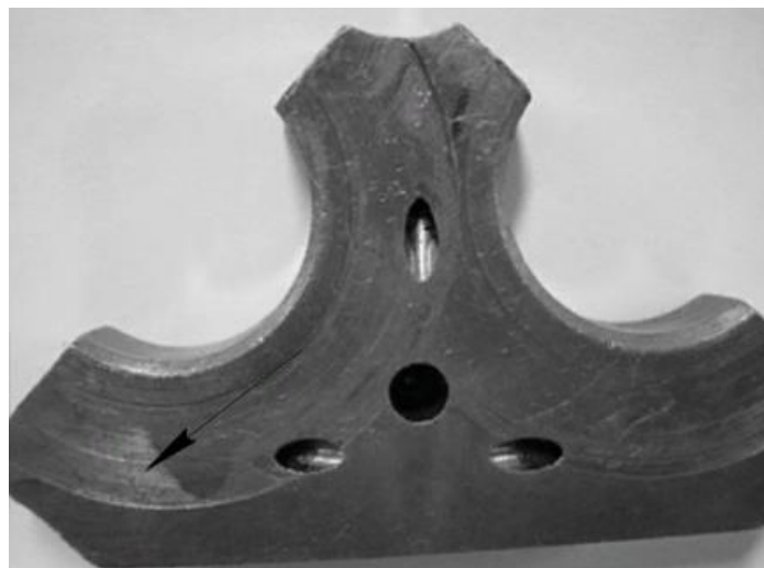
Рисунок 2.1 – Вигляд зношеної торцевої пластини насосу НШ.
