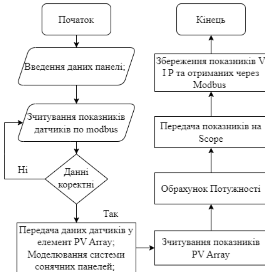
Рисунок 3.4 – Блок-схема алгоритму роботи
