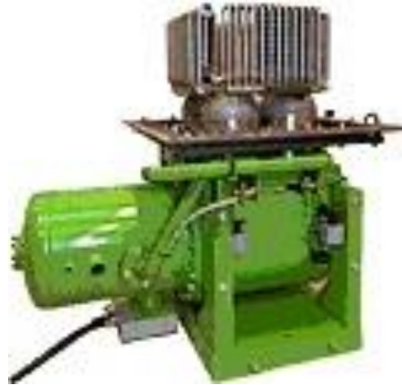
Рисунок 1.2 – Двигун Стірлінга, потужністю 28,5 кВт, що працює на деревній трісці
