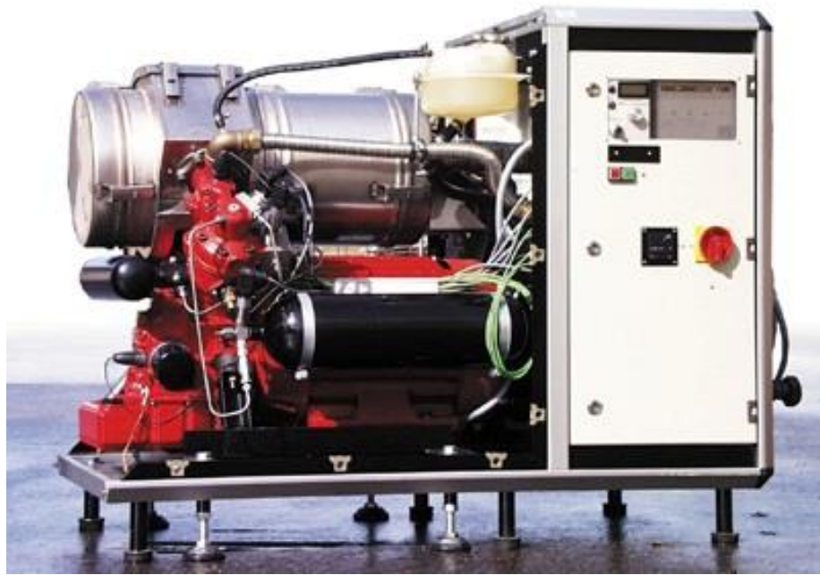
Рисунок 1.1 – Двигун Стірлінга, що працює на природному газі, потужністю 9 кВт
