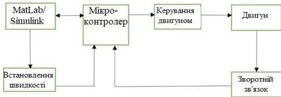
Рисунок 2.6 - Структурна схема керування двигуном постійного струму робота
