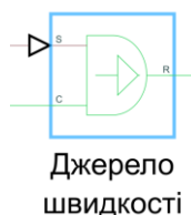
Рисунок 3.6 - Блок джерело швидкості із бібліотеки Simscape/Foundation Library/Mechanical/Mechanical Sources
