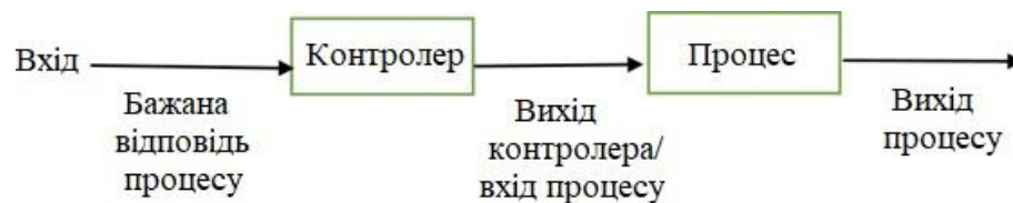
Рисунок 2.4 - Структурна схема розімкнутої системи керування
