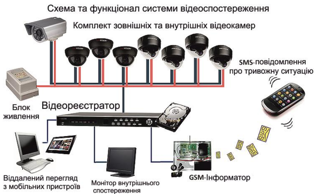
Рисунок 3.4 Принцип роботи охоронного відеоспостереження
