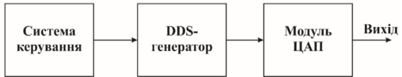
Рис. 9. Структурна схема лабораторного макету
