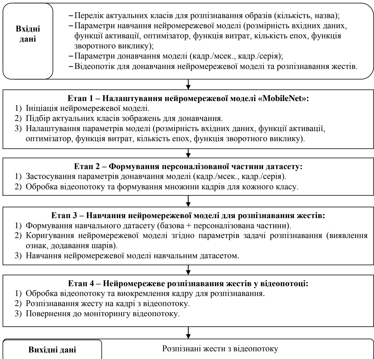
Рисунок 2.1 – Схема методу нейромережевого розпізнавання жестів у відеопотоці
