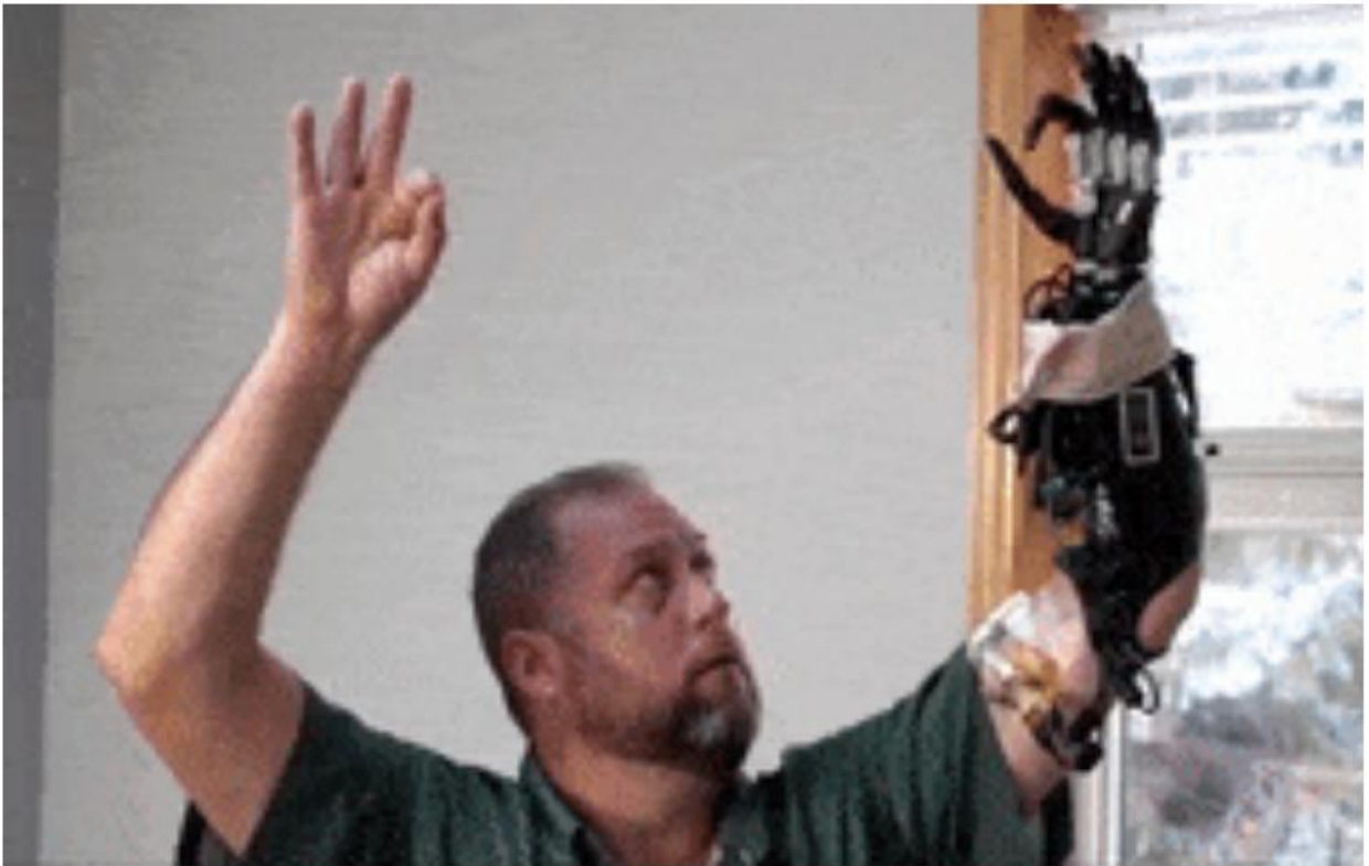
Рисунок 1.6 – Демонстрація роботи біонічної руки за використанням штучного інтелекту для розпізнавання жестів [20]
