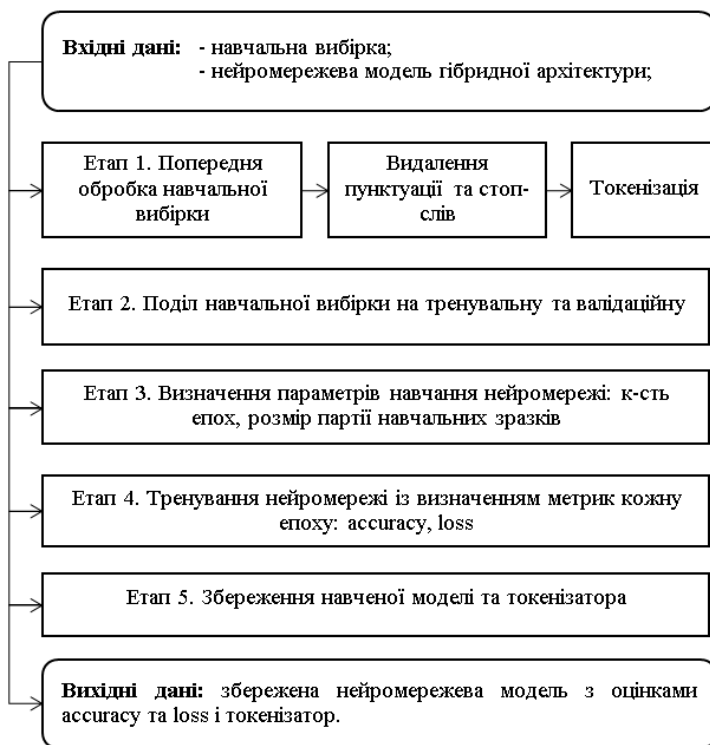
Рисунок 4 – Схема навчання нейромережі гібридної архітектури
