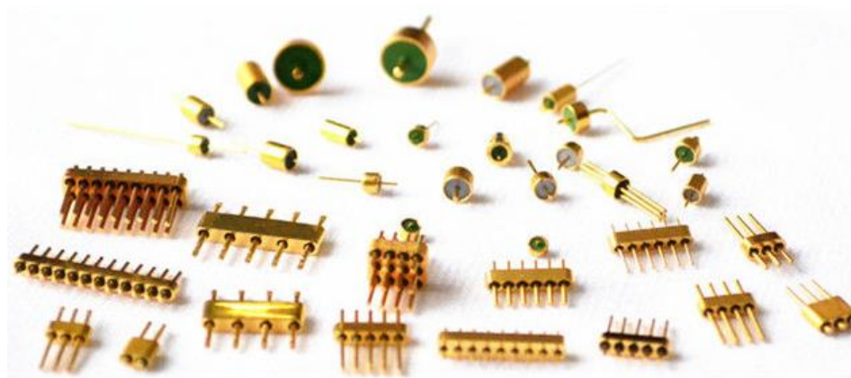
Рис. 1.1 – Сучасні елементи РЕА, виготовлені за технологією скляного спаювання
