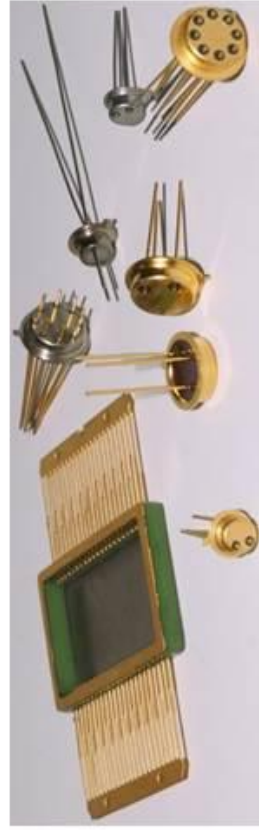
Рис. 1 – Сучасні елементи РЕА, виготовлені за технологією склоспаювання
