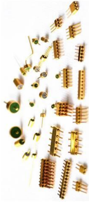
Рис. 1 – Сучасні елементи РЕА, виготовлені за технологією склоспаювання
