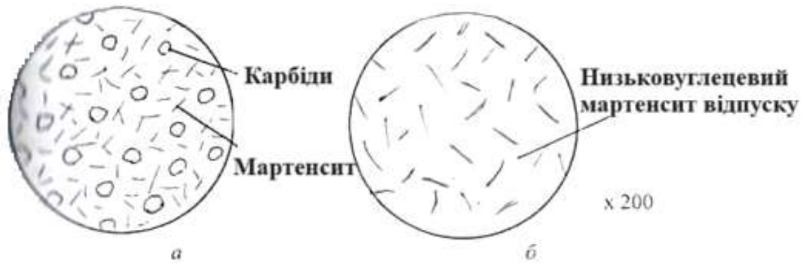
Рисунок 2.5 – Структура відпущених мартенситу (а) і низьковуглецевого мартенситу (б)
