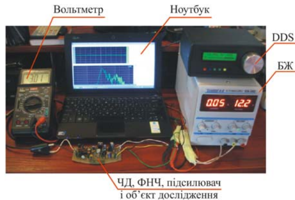
Рис. 1. Лабораторний стенд дослідження характеристик КР: а) в ручному режимі; б) в автоматичному режимі. DDS – цифровий синтезатор, ЧД – частотний дискримінатор, ФНЧ – фільтр низької частоти
