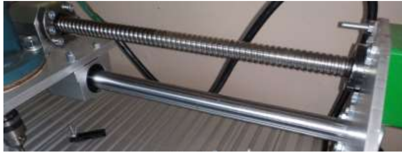
Рисунок 2.13 – Гвинтова пара в зборі
