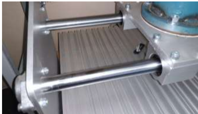
Рисунок 2.14 – Напрямна для переміщення ЛЕМД
