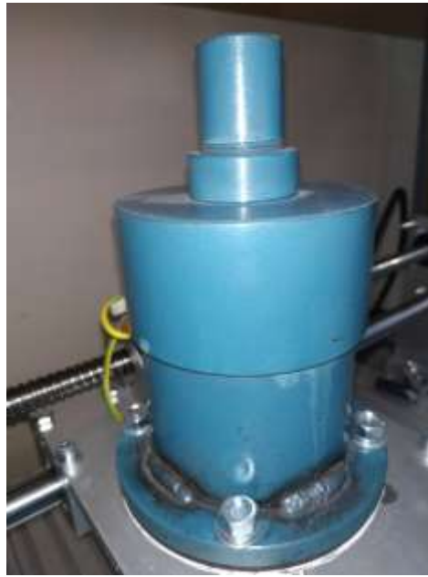
Рисунок 2.19 – Фото розробленого електромагнітного двигуна
