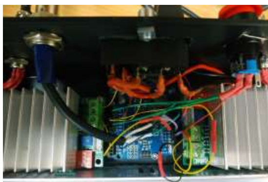
Рисунок 2.30 - Підключення контролера Arduino UNO
