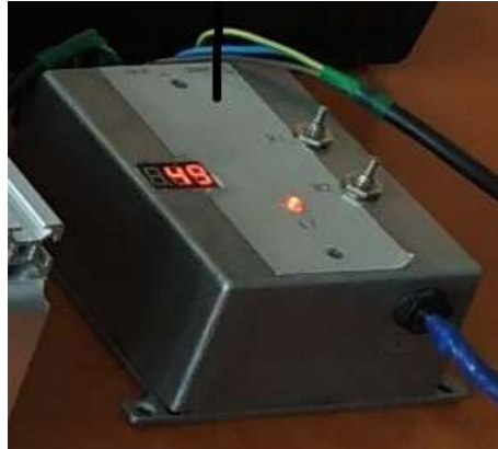
Рисунок 2.32 – Фото розробленого пристрою живлення та керування ЛЕМД
