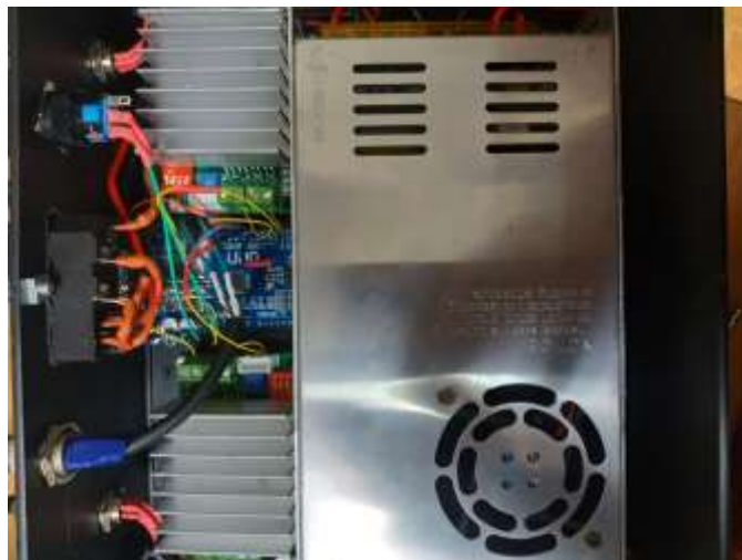
Рисунок 2.31 – Загальний вигляд пристрою живлення драйверів крокових двигунів
