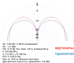
Рис. 2 – Ескіз клеверної антени з електричними параметрами
