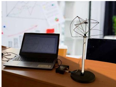
Рис. 2 – Макет на базі аналізатора спектра Simple Vector Network Analyzer та ПЗ «VNA View»
