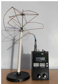
Рис. 1 – Зібраний макет антени з ємнісним навантаженням та підтверджуючими показниками працездатності на аналізаторі MFJ-269
