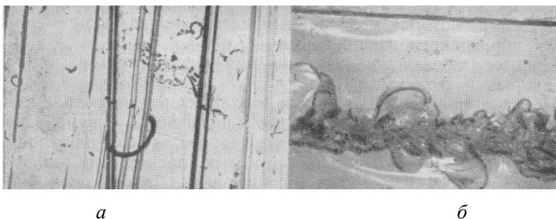
Рис. 1.5. Сліди в'язкого руйнування поверхневого шару сталюго зразка під дією гострих и твердих абразивних зерен X 10 ( а ) і крихке руйнування поверхневого шару скла при uszkodженні абразивною частинкою X 8 ( б )
