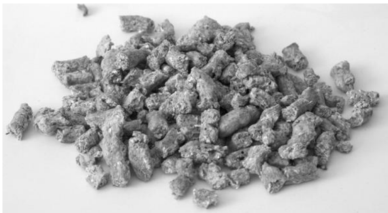
Рис. 6.3. Загальний вид екструдату з різних компонентів: a тиск – 4,5 МПа, температура – 145 °С; б тиск – 3 МПа, температура – 150 °С
