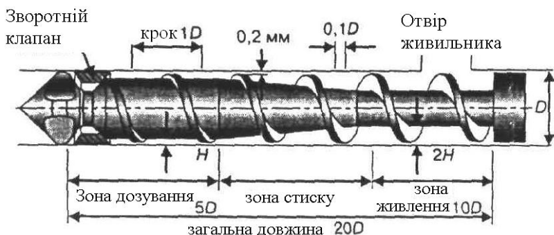
Рис. 7.3. Типовий шнек пластифікатора для лиття під тиском
