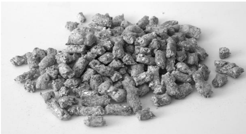
Рис. 6.2. Загальний вид екструдату з різних компонентів: a тиск – 6 МПа, температура 150 °С; б тиск – 4 МПа, температура 140 °С
