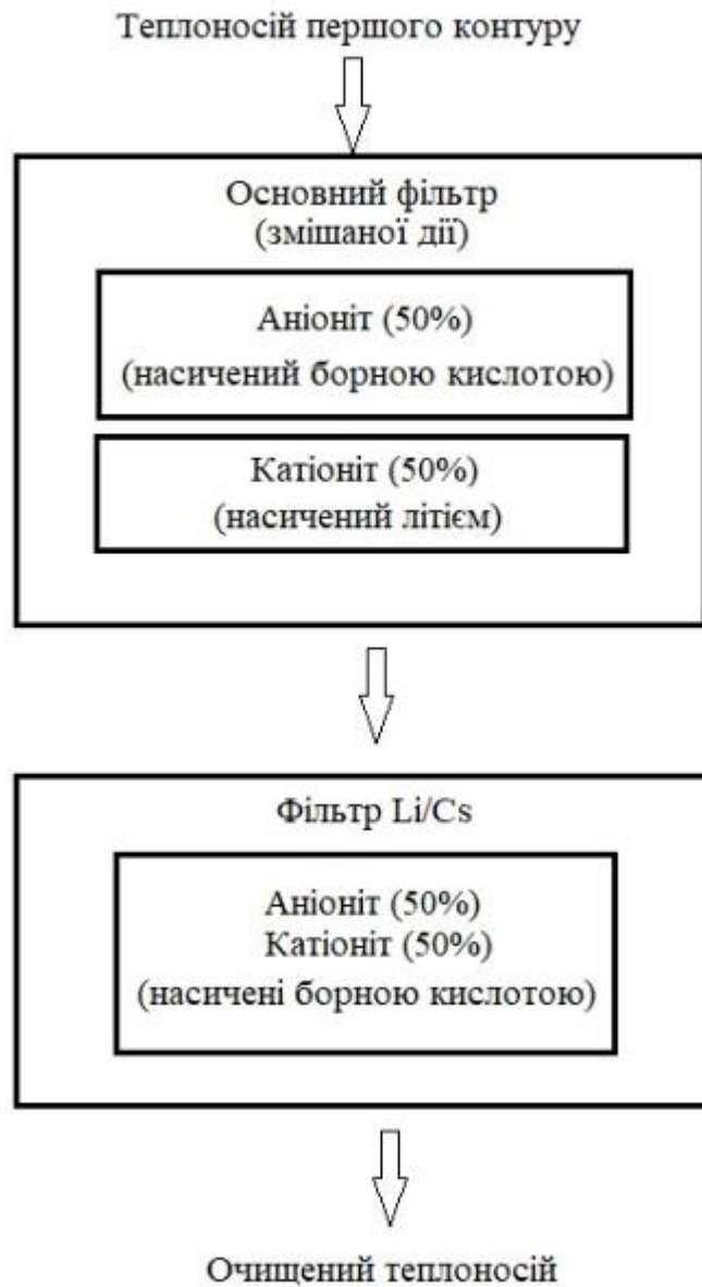
Рисунок 14 – Схематичне зображення складу фільтра змішаної дії
