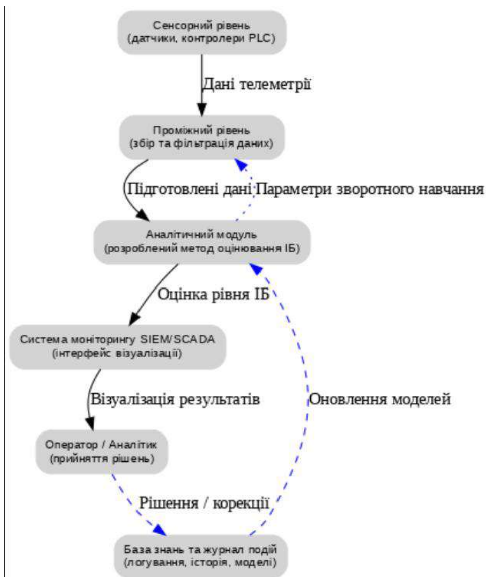
Рисунок 19 - Узагальнена схема інтеграції методу в систему моніторингу ІБ
