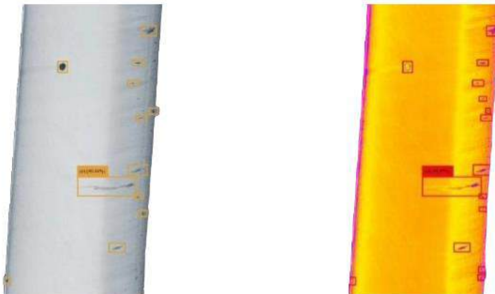
Рисунок 3.3 – Результати порівняння виявлення дефектів на RGB-зображенні
