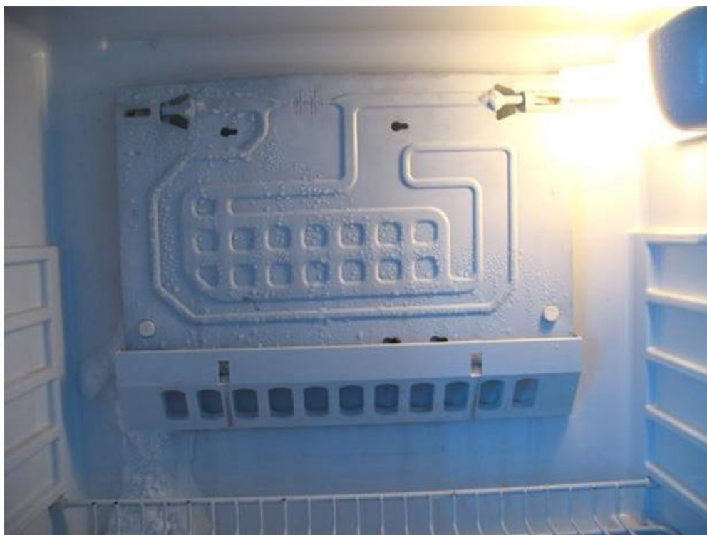
Рисунок 1.5 - Закрито-трубчастий випарник, поміщений в стінку холодильника
