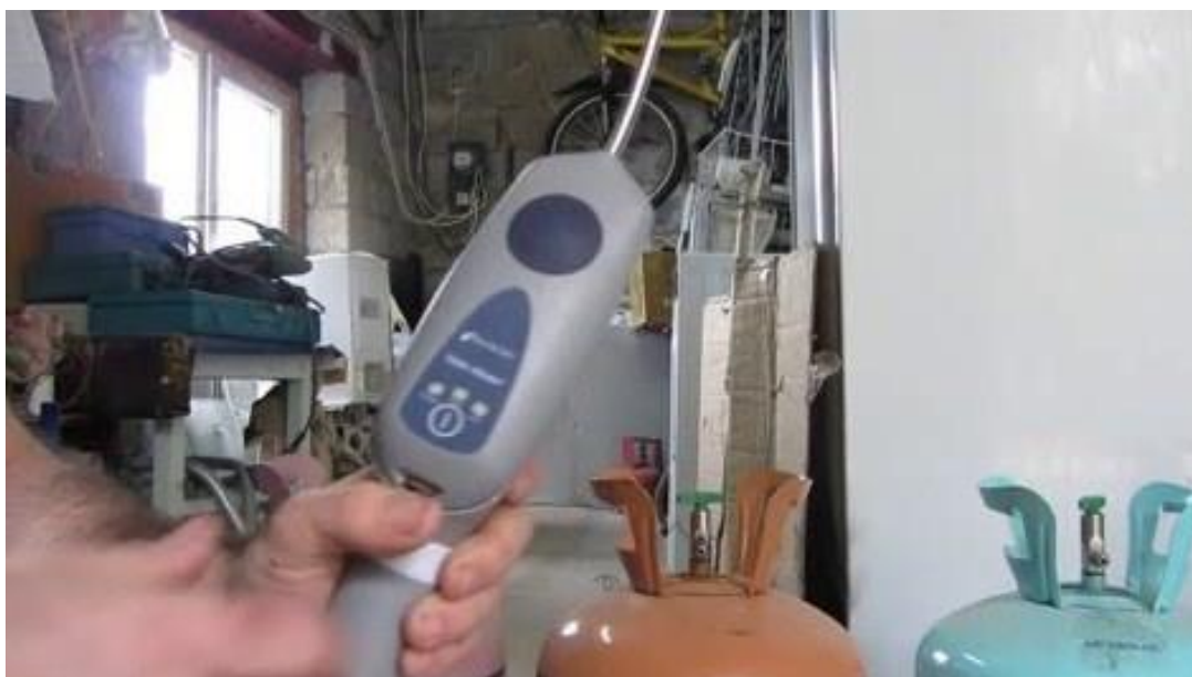
Рисунок 5.2 – Пошук витоку холодоагенту за допомогою витокошукача
