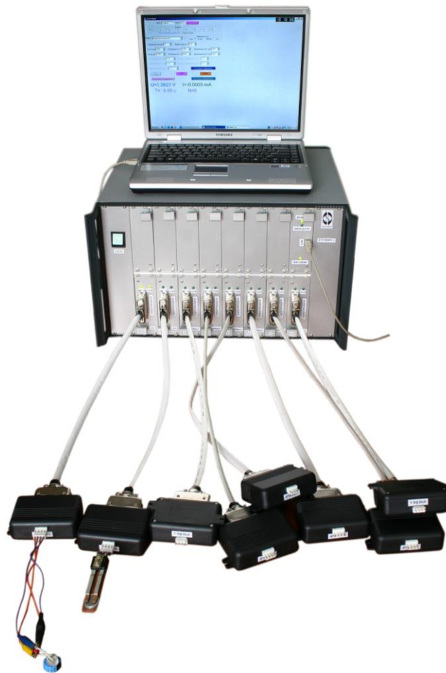
Рисунок 4.1 – Прилад для удосконаленого методу діагностування стану накопичувачів електроенергії на змінному струмі
