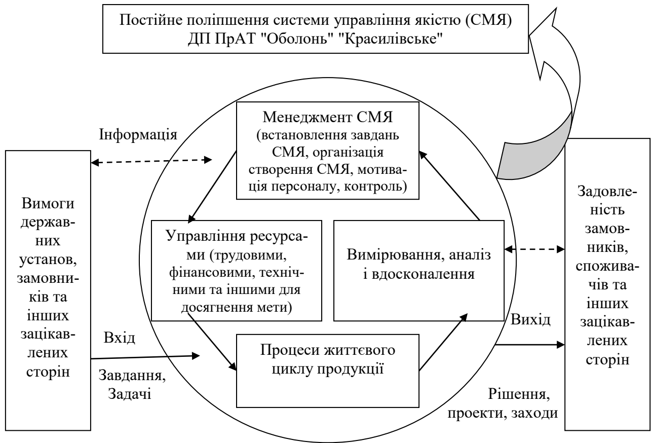
Рисунок Б.1 – Модель системи управління якістю, що базується на процесному підході, для ДП ПрАТ "Оболонь" "Красилівське"
