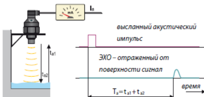
Рисунок 4.5 - Принцип дії ультразвукового вимірювання рівня
