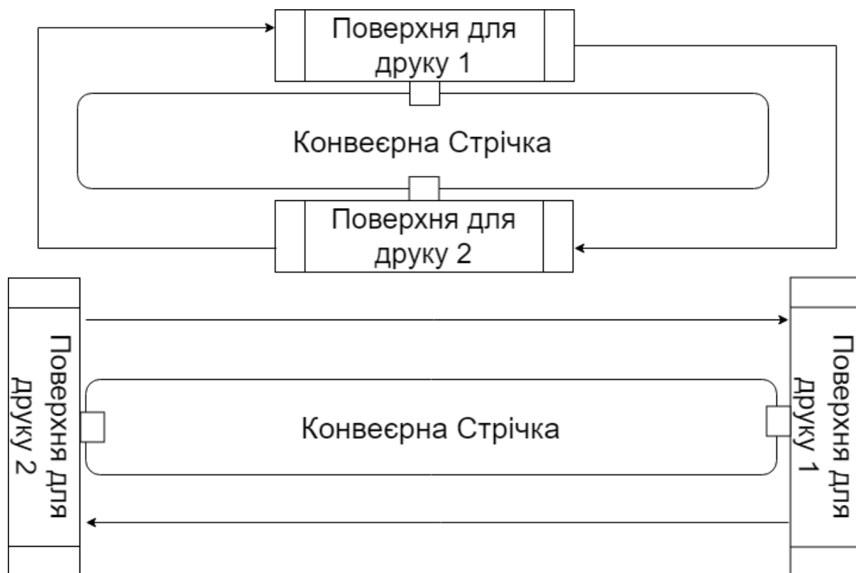
Рисунок 3.14 - Цикл роботи абстрактної моделі, вид збоку
