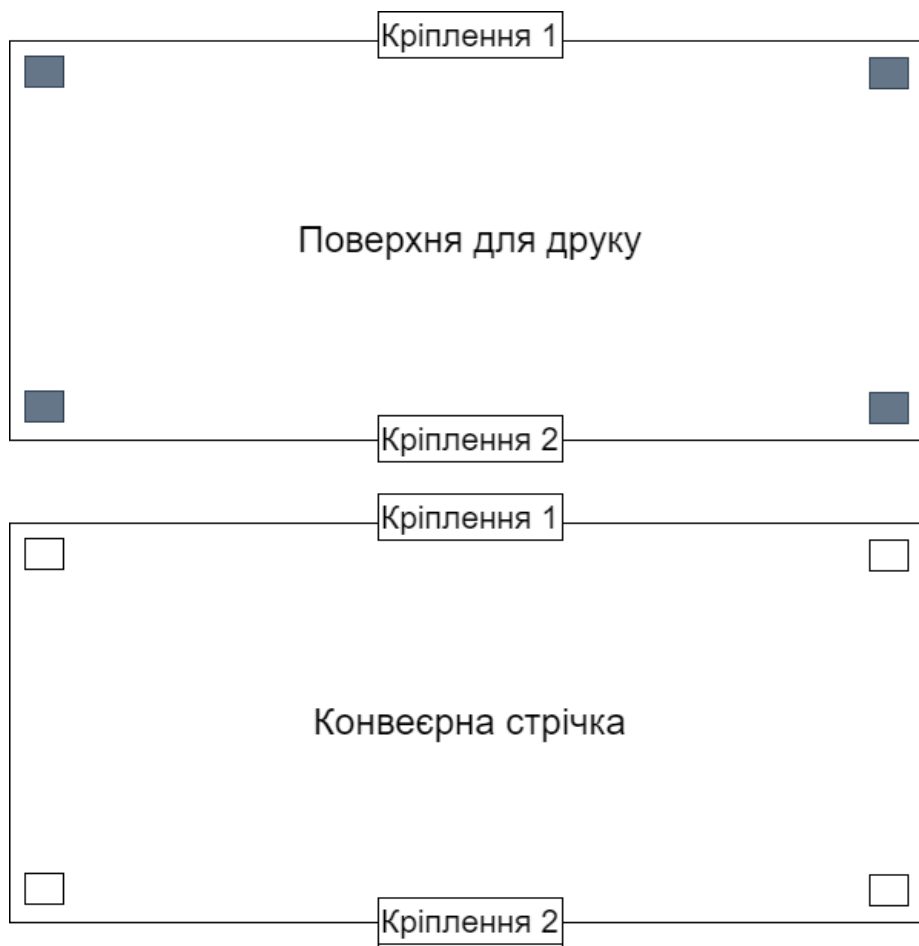
Рисунок 3.15 - Схема встановлення магнітів у поверхні
