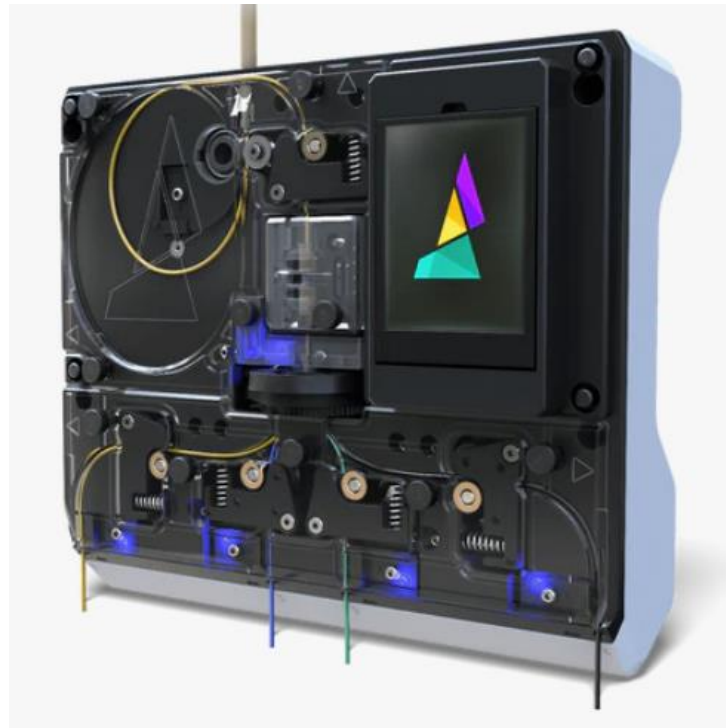
Рисунок 1.4 - внутрішня частина Palette 2
