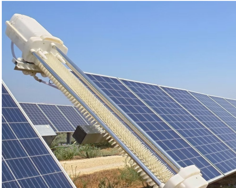
Рисунок 1.2 - модульна система очищення сонячної панелі з використанням щітки та води
