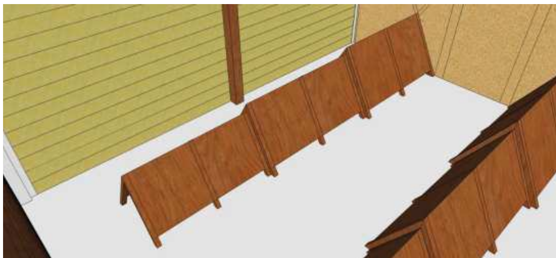
Рисунок 2.11 – Розподільчі канали, складені з трьох секцій.
