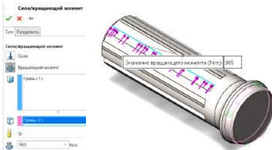
Рисунок 4.30 – Дефініція опор шліцевого валу (а) та прикладення до нього навантаження (б)
