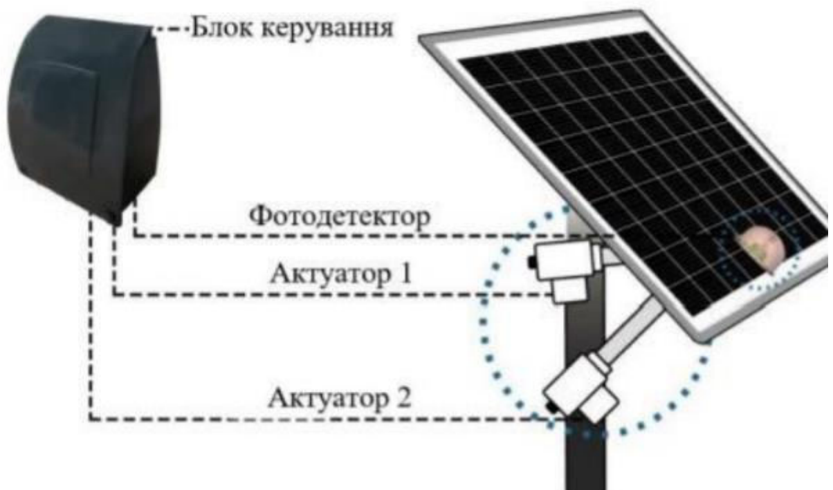
Рисунок 1.4 – Система позиціонування трекера на фотоприймачах
