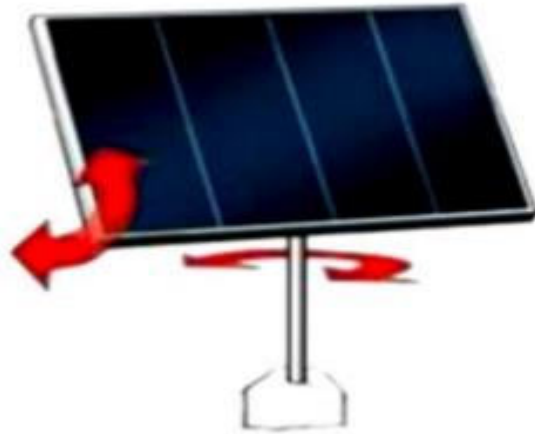
Рисунок 2.7 - Трекер з двома осями обертю на несучій конструкції.
