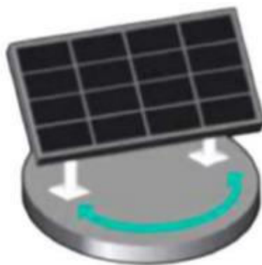
Рисунок 2.5 - Трекер з вертикальною віссю обертання
