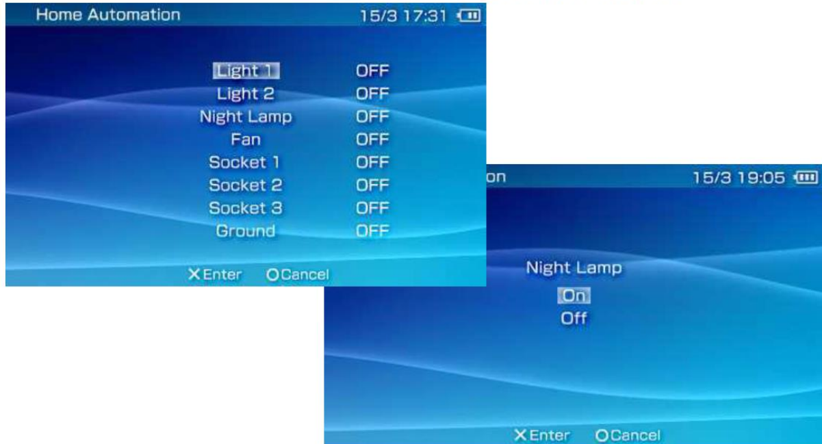
Приклад керування з клієнтського модулю на Playstation Portable 9
