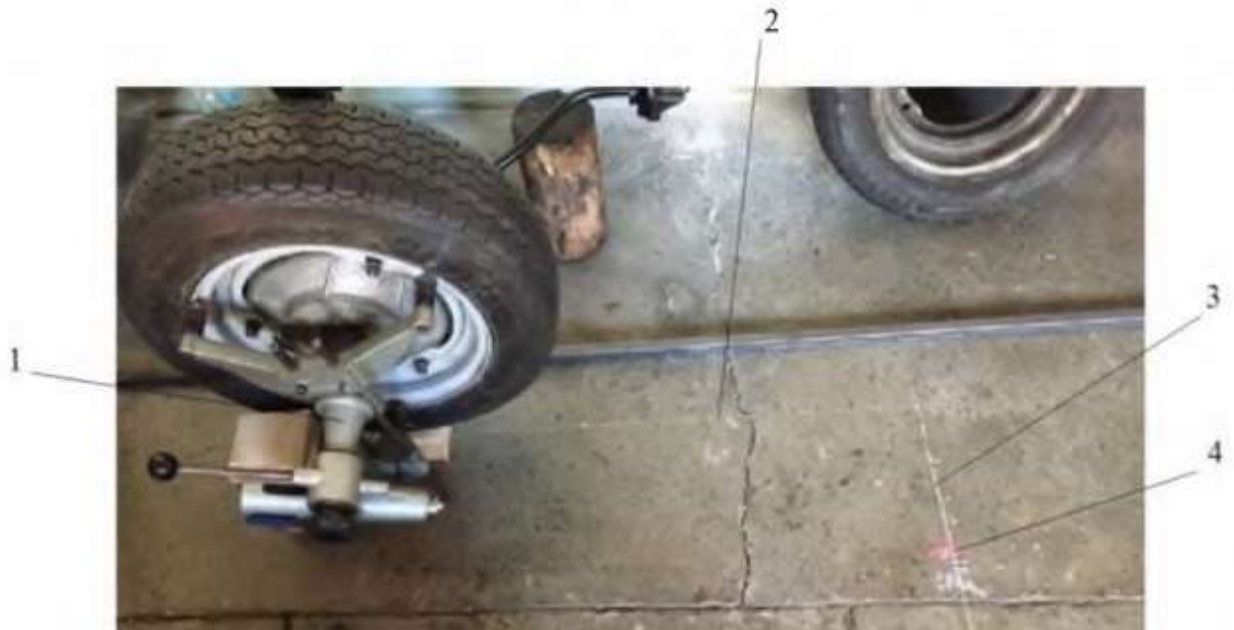
Рис. 17 – Процес фіксації зміни кута сходження колеса в залежності від ходу підвіски: 1 - пристрій для регулювання кутів розвалу та сходження; 2 - лінія паралельна площині обертання колеса; 3 - перпендикуляр; 4 - точка перетину промінню перпендикуляру
