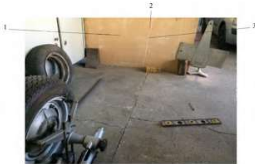
Рис. 15 – Обладнання для фіксації змін кута розвалу колеса в залежності від ходу підвіски: 1 – вимірювальний стенд; 2 – нульова точка; 3 – лінія, що відповідає площині положення колеса
