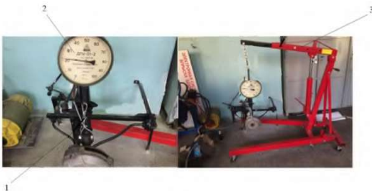
Рис. 20 – Система вимірювання жорсткості стабілізатора:
