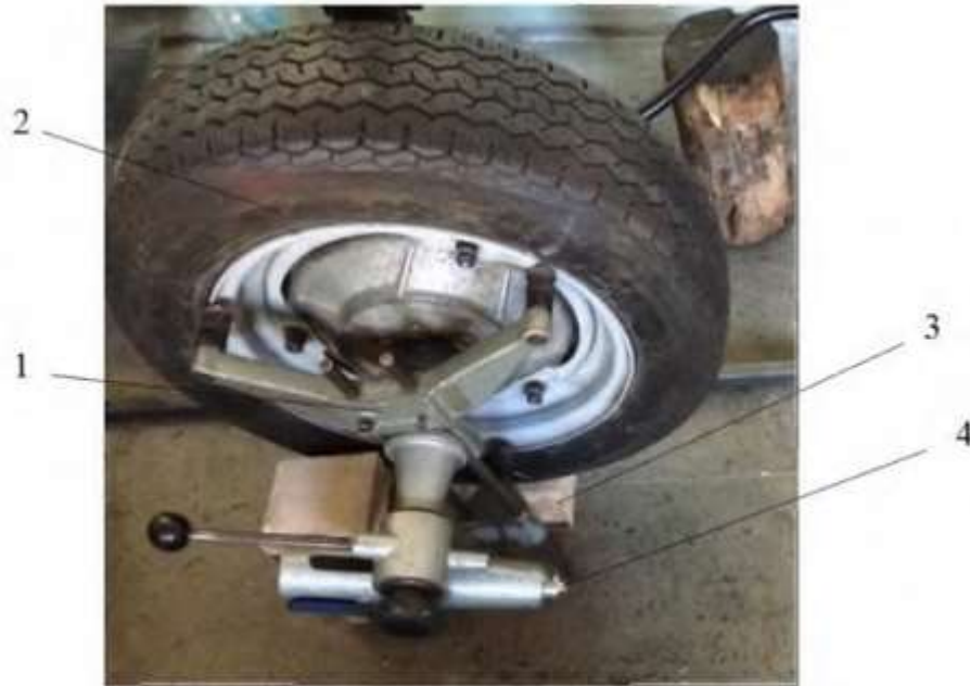
Рис. 14 – Пристрій для визначення кутів розвалу та сходження колеса: 1 - пристрій для регулювання кутів розвалу та сходження; 2 - колесо; 3 - бруски для регулювання ходу підвіски; 4 – лазер
