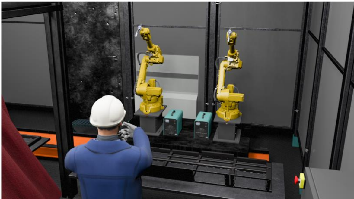
Рисунок 2.12 – Розташування роботів в роботизованій зварювальній комірці
