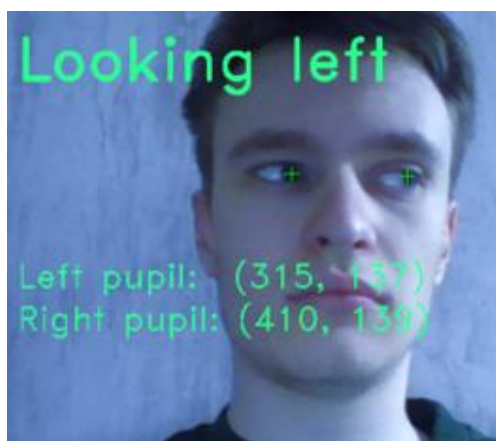
Рисунок 1.5 – Демонстрація знаходження координат зіниці, використовуючи аналіз відеопотоку OpenCV [8]
