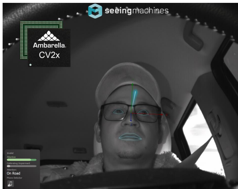
Рисунок 1.1 – Інтегрована система моніторингу водія та ADAS від Seeing Machines та Ambarella [6]
