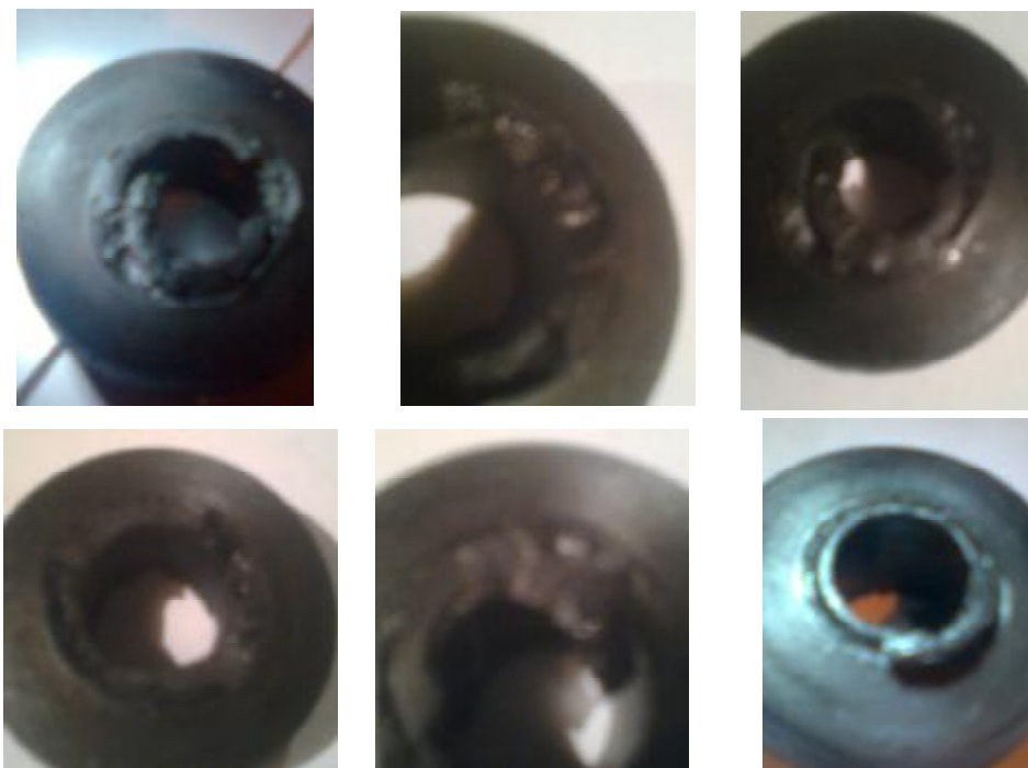
Рис. 2. Виды разрушений краев внутреннего отверстия резиновых элементов
