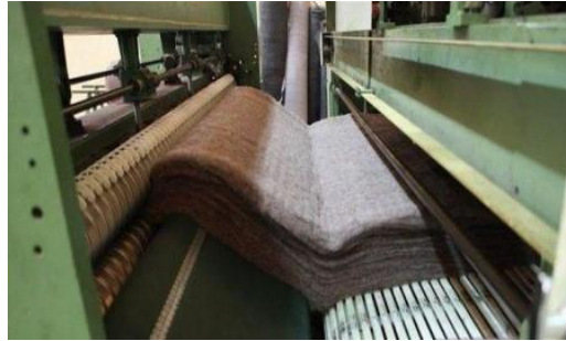
Рисунок 1.1.1 – Голкопробивний метод промислового виготовлення повсті
