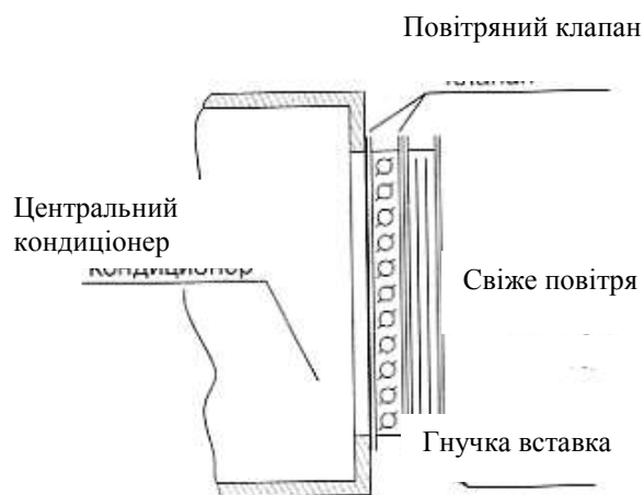
Рисунок 2.8 - Повітряний клапан, встановлений на вході в центральний кондиціонер
