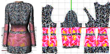
Рис. 13. Розгортки сегментів стану та рукава (в середовищі Rhinoceros) розташування членувань рукава L_p
