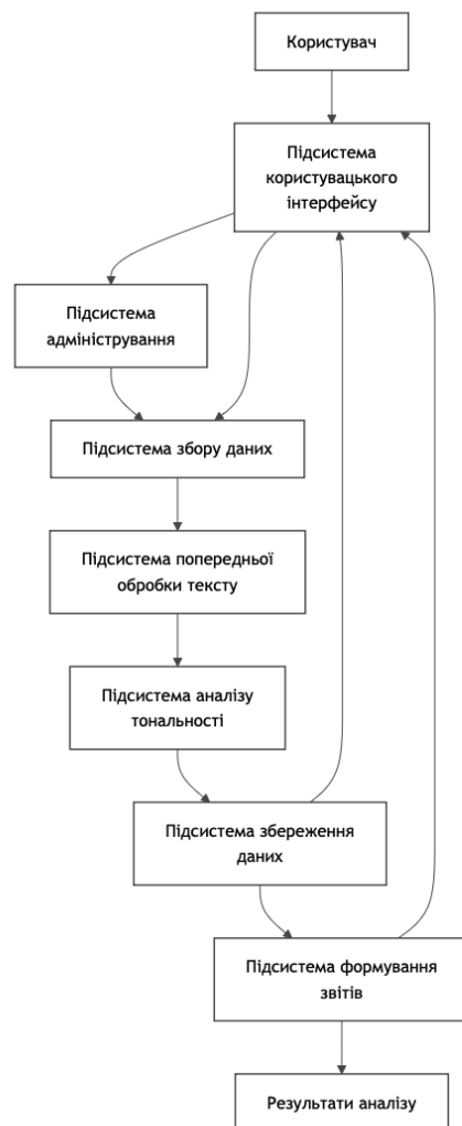
Рисунок 2.1 – Схематичне зображення взаємодії підсистем
