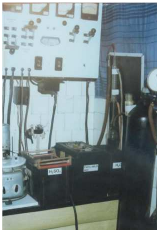
Рисунок 2.3 – Установка для нанесення електролітичних покриттів заліза.
