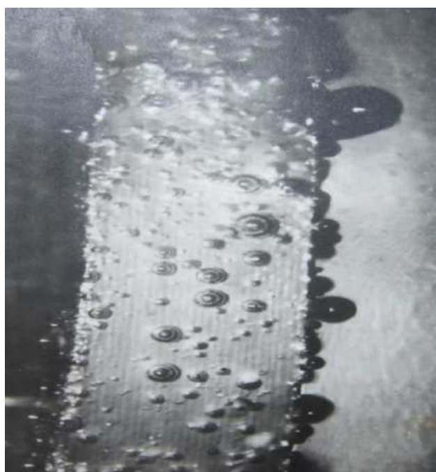
Рисунок 3.24 – Адсорбція водню, що виділяється при електролізі, на поверхні катода
