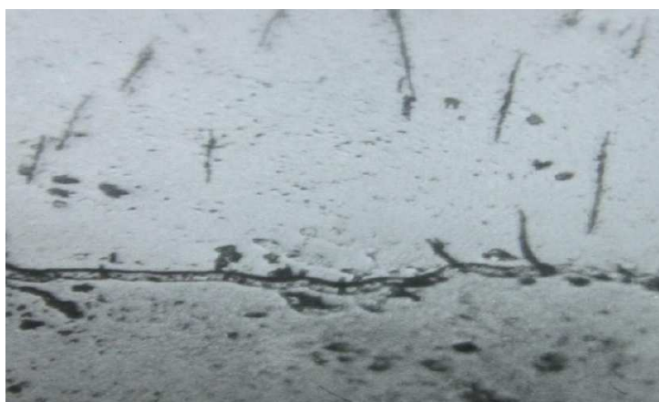
Рисунок 3.10 – Включення гідроксиду в шари за рахунок залужування прикатодного шару
