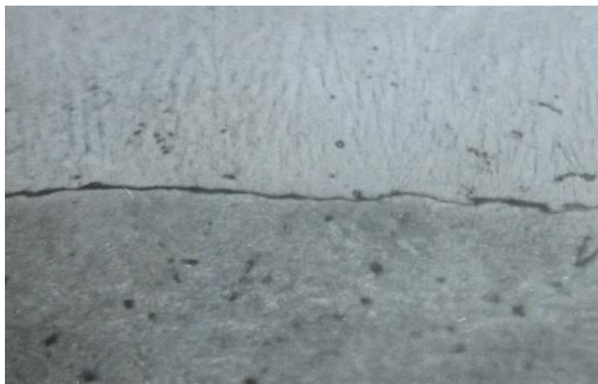
Рисунок 3.3 – Структура покриття електролітичного заліза, одержаного в проточному електроліті.
