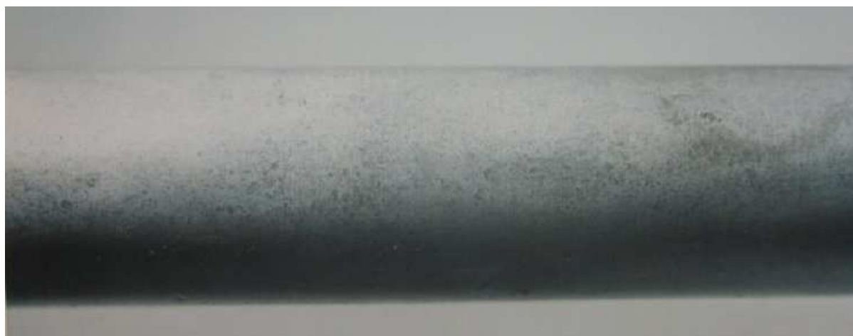
Рисунок 3.27 – Зразок, отриманий під час залізнення зі створенням розрідження над дзеркалом електроліту
