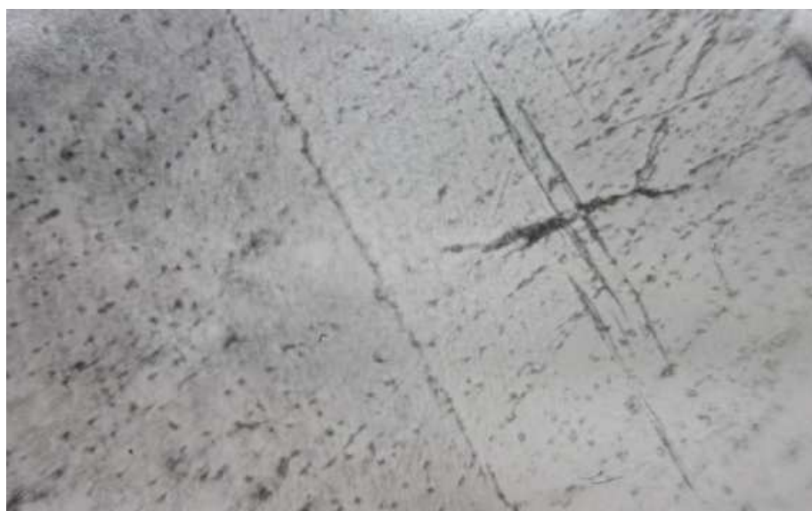
Рисунок 3.28 – Структура електролітичного заліза, одержаного у звичайних умовах
