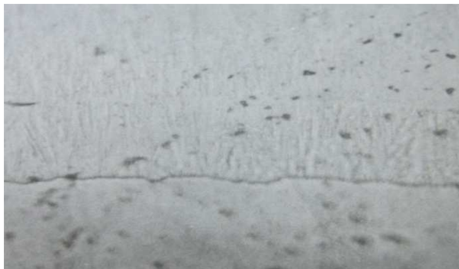
Рисунок 3.5 – Неметалічні включення, що випадково внесені в покриття при електролізі.
