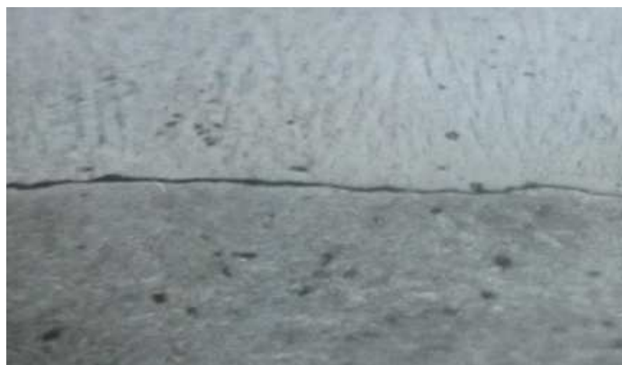
Рисунок 3.13 – Мікроструктури електролітичного заліза, отриманого при щільності струму 8...10 А/дм 2
