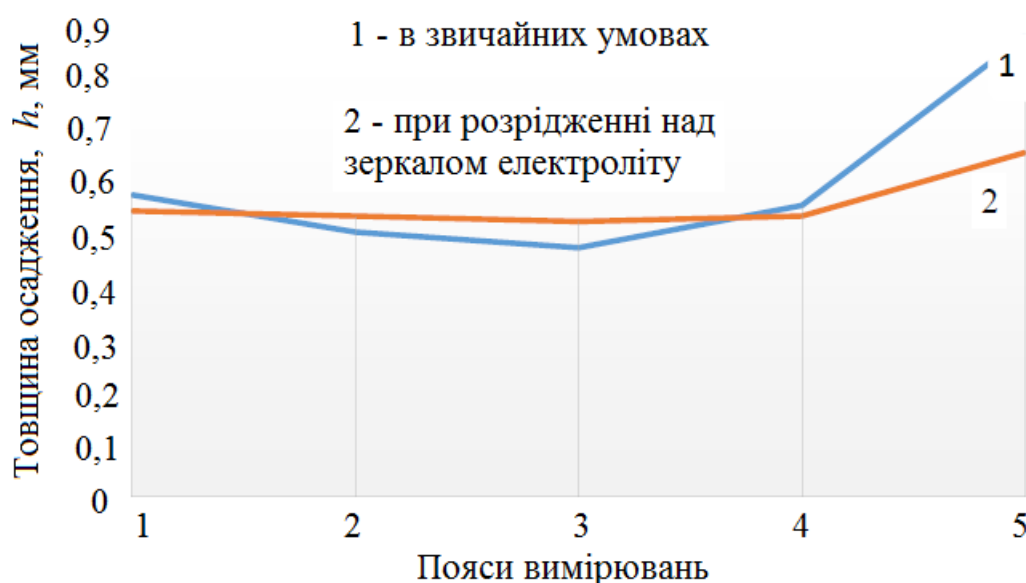
Рисунок 3.22 – Розподіл електролітичного залізного покриття за довжиною зразка:
