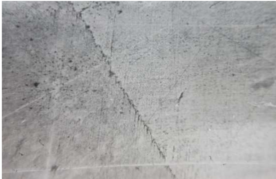
Рисунок 3.29 – Структура електролітичного заліза, одержаного при розрядженні над дзеркалом електроліту
