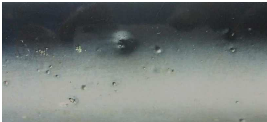
Рисунок 3.25 – Піттинг на поверхні зразка внаслідок тривалої адсорбції водню.
