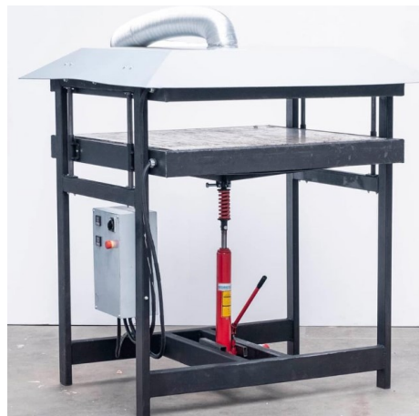
Рис.4. Прес для переробки відходів пластику у листи
