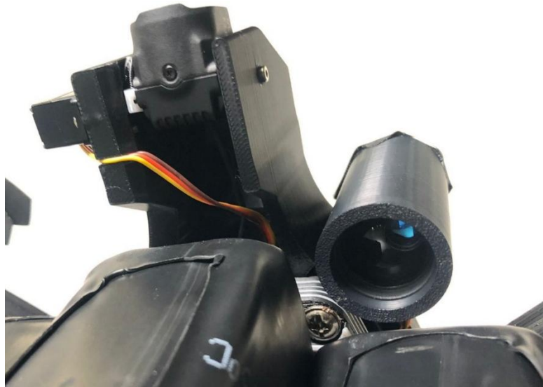
Рисунок 4.6 – Встановлений лідар на квадрокоптері
