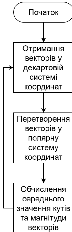
Рисунок 3.6 – Блок-схема алгоритму перетворення оптичного потоку в напрямок руху БПЛА
