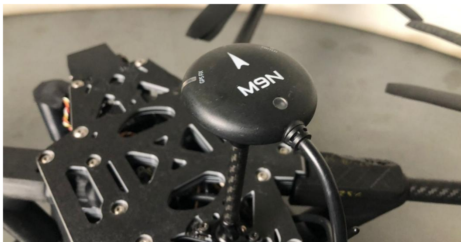
Рисунок 4.4 – Модуль GPS, встановлений на квадрокоптері
