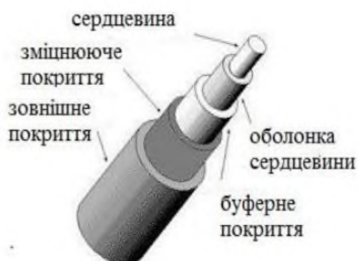
Рисунок 1.1 – Схема побудови оптоволоконного кабелю
