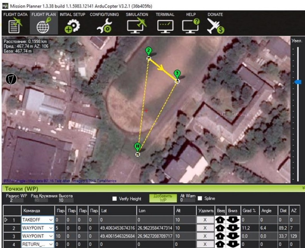
Рис. 6. Планирование миссии БПЛА по путевым точкам в ПО Mission Planner
