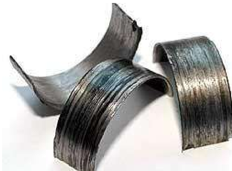
Рисунок 16 – Задири на підшипниках
