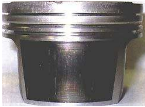
Рисунок 4 – Поршень з антифрикційним покриттям
