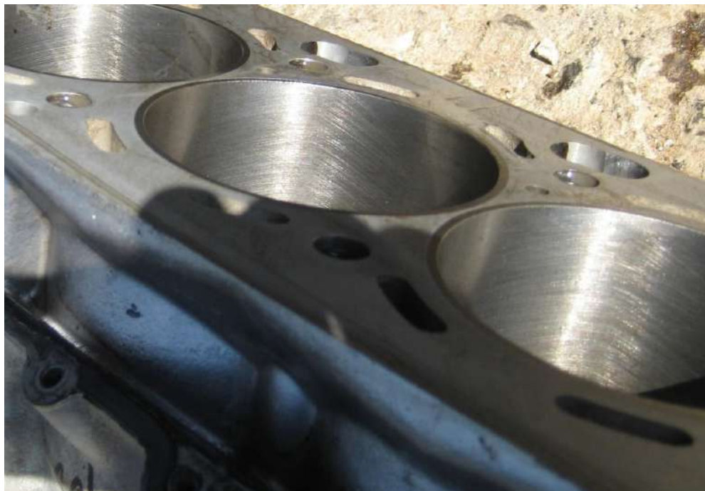
Рисунок 17 – Поверхня циліндрів після хонінгування
