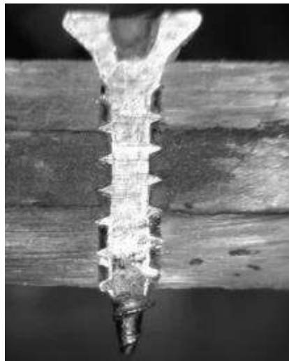
Рисунок 28 – Поперечний розріз зразка нахлесточного з'єднання з армуючим елементом: а) вихідний; б) модифікований.
