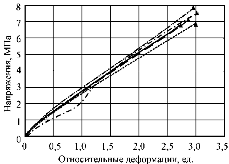
Рисунок 23 – Діаграми деформування при розтягуванні еластичної клеювої композиції
