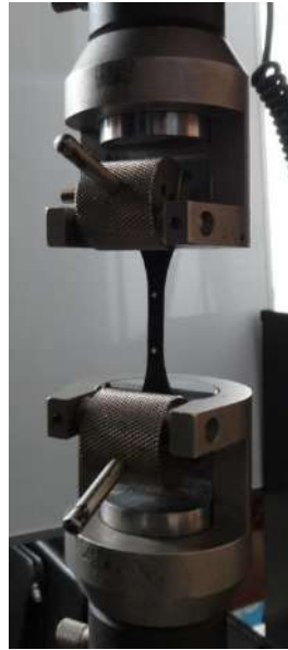
Рисунок 21 – Вид зразка з мітками для випробувань на розтягування
