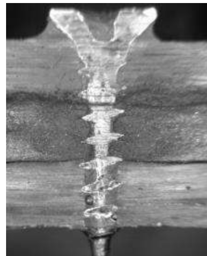
Рисунок 28 – Поперечний розріз зразка нахлесточного з'єднання з армуючим елементом: а) вихідний; б) модифікований.
