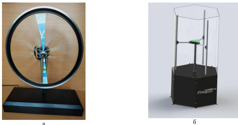
Рис. 10. Стенд для формування динамічно розгорнутого кольорового зображення: а) формування зображень в площині, б) формування зображень в просторі
