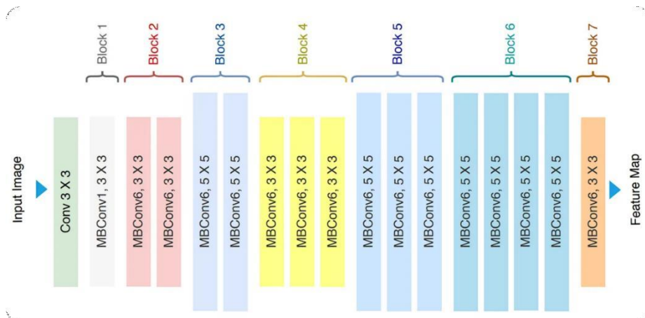
Рисунок 1.3 – Архітектура EfficientNet-B0 та принцип compound scaling [5]
